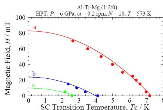
Al:Ti:Mg=1:2:0の組成比で見つかった3つの超伝導相の超伝導転移温度の直流磁場依存性
