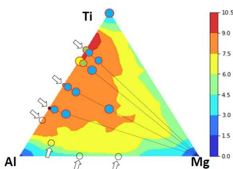
機械学習によって予測された超伝導転移温度を表す三元系状態図
